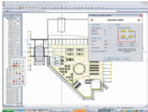
3 Stejný model slouží v DDS pro všechny profese. Program „dimenzuje“ sám, např. pro návrh osvětlení se zadají požadavky na místnost a typ svítidla, osazení je provedeno automaticky
