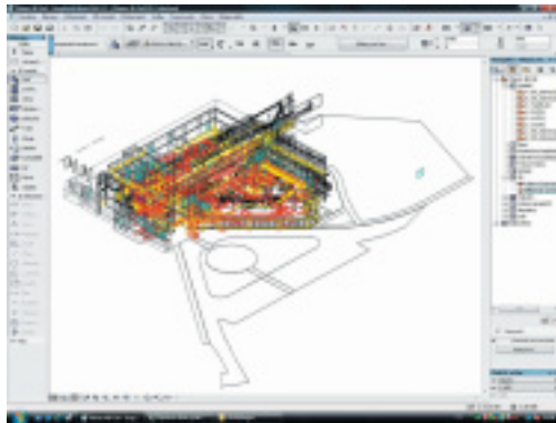
4 Architekt může dostat zpět 3D model se všemi profesemi (nebo třeba jen 2D schémata elektro-rozvodů) do ArchiCADu. Ve 3D zobrazená stejná scéna jako na předchozím obrázku v DDS
