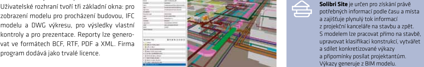
POHLED NA KOORDINACI INSTALAČNÍCH ROZVODŮ POD STROPNÍM I. PP. SPOLEČNĚ SE ZOBRAZENÍM PODROBNÝCH INFORMACÍ VYBRÁVĚNÉHO ELEMENTU. PROJEKT ČTVRT EMILIA KOLBENA 2, SKANSKA REALITY A.S.
