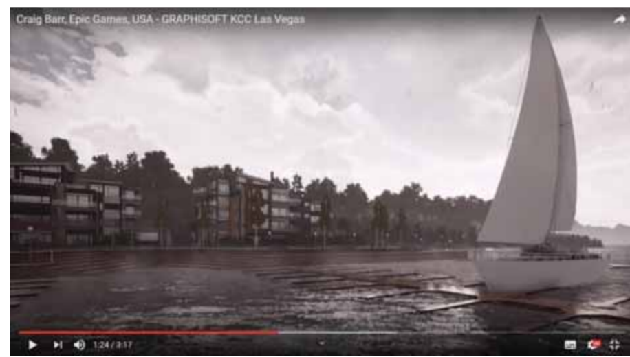
Na vizualizaci, kterou nabízí renderovací engine Unreal Engine, je podstatné to, že je počítána v reálném čase, tedy že s takto zobrazeným modelem (ray-tracing) lze procházet (snímek obrazovky z YouTube)
